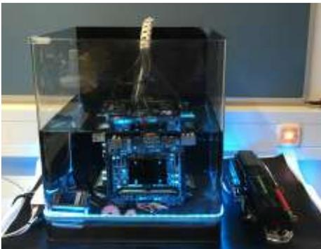
In der zweiten Version des Projekts wird es um ein modulares Anschlusssystem erweitert, damit ein Austreten des Öls aufgrund des Kapillareffekts verhindert wird. Zusätzlich werden dadurch die Transportfähigkeit sowie die Möglichkeiten für ein späteres Warten der Rechner und Komponenten erhöht.
