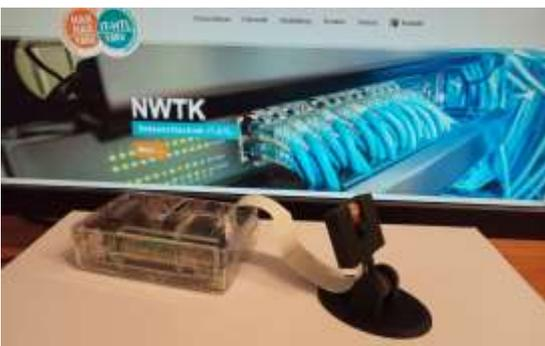
Bildschirmschaden oder einen Systemcrash, was bei gewöhnlicher Überwachung unmöglich ist. Das gesamte System läuft auf einem Raspberry Pi mit einer PI Kamera, wodurch das System auch wirtschaftlich ist. Des Weiteren wird bei Ausfall eine Benachrichtigung entweder per E-Mail oder per SMS gesendet.
